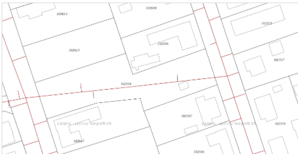
80 cm-es betoncsatorna tengelye
