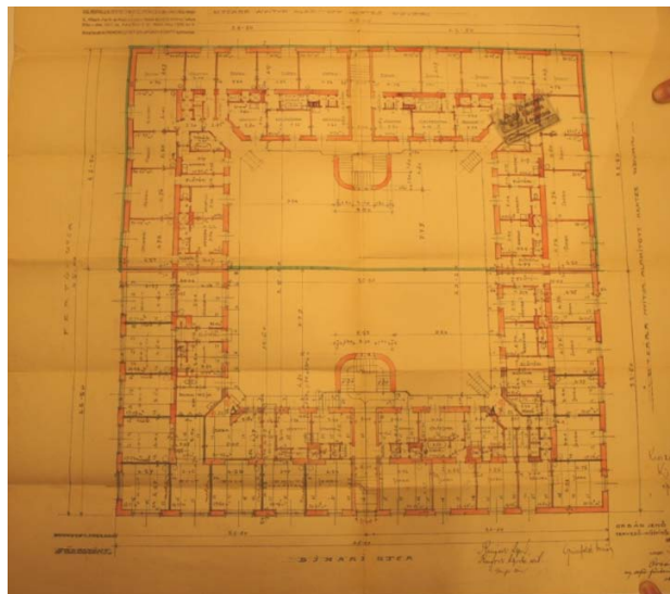
Földszint (az alaprajzon jól látszik a tükörképként tervezett, de végül meg nem valósult bérház)
